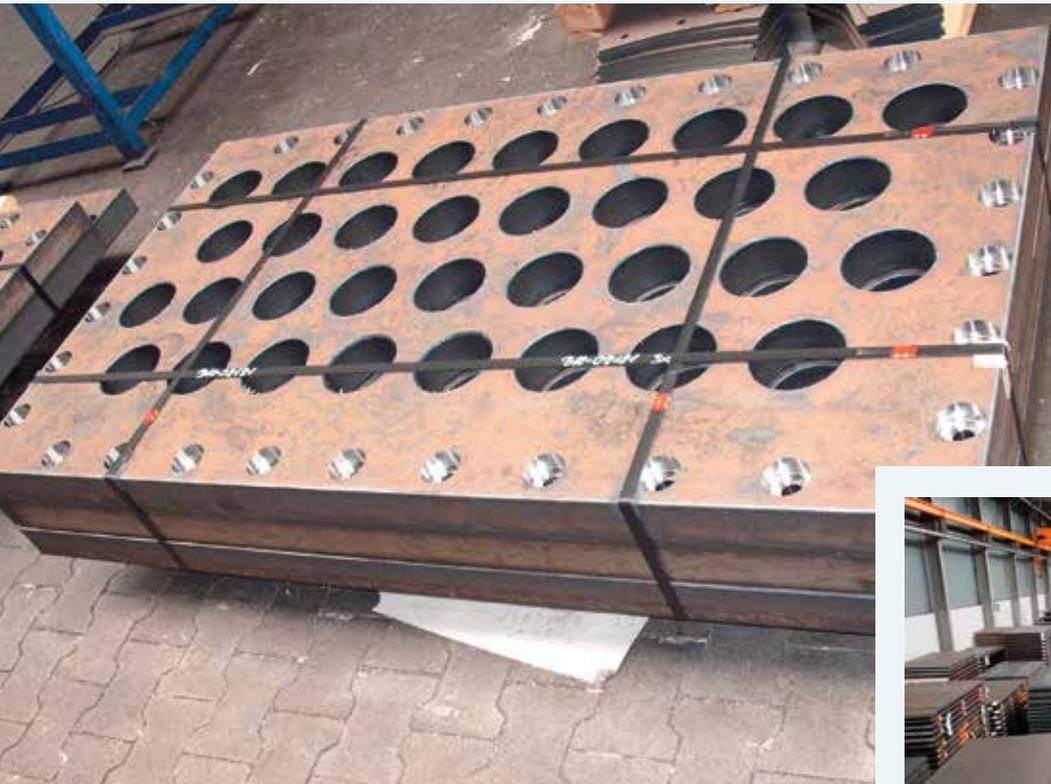
**STAHL IN FORM:** Lochblech für eine Siebmaschine. Fotos: Unionstahl
